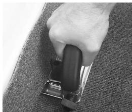
2. Rester la plaque pour la base sur le tapis à plat et déplacer la guide contre le mur et couper le tapis.
