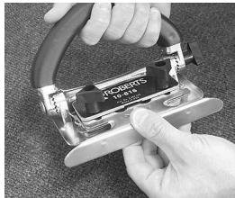
3. Insérer le porte lames au-dessus de la plaque de localisation. Ajuster le porte lame selon le type de tapis à couper.
