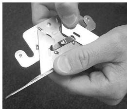
Enlever les vieilles lames tel qu'illustré. Insérer une nouvelle lame au-dessus de la pince à ressort et les guides surélevés. Lorsqu'un côté de la lame est non-tranchant, vous avez qu'à utiliser l'autre côté. Note: Utiliser que les lames de Roberts pour cet outil. Conseil: Lorsque la lame est dans la bonne position vous devriez être capable de voir l'écriture sur la lame.
