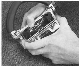
2. Insérer la plaque de localisation entre les espaces à la hauteur voulue, en utilisant les encoches à chaque bout. L'emplacement moyen sera au-dessus du quatrième espaceur. Si la coupe est trop longue, déplacer la plaque d'une à deux espaces plus bas. Si la coupe est trop courte, déplacer la plaque d'une à deux espaces plus haut.
