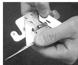
Cambie las cuchillas como lo indica el gráfico. Inserte la cuchilla nueva debajo del resorte. Cuando solo un extremo de la cuchilla esta sin filo, cambiala a la otra posición para doblar la vida de la cuchilla. Note: solamente use cuchillas ROBERTS en este cortador. Para obtener una mayor satisfacción, asegúrese de que pueda leer lo impreso en la cuchilla una vez que este en su posición para ser usada.
