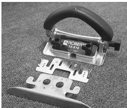
1. Tres partes básicas de su cortador: (de arriba hacia abajo) mango, placa y soporte de la cuchilla.
