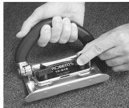
3. Inserte el soporte de la cuchilla sobre la placa. Ajuste la dimensión "hacia fuera y hacia dentro" según el tipo de alfombra que va a cortar.
