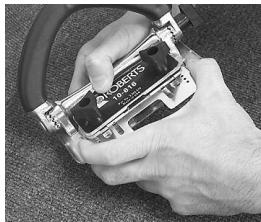
2. Inserte la placa entre los espaciadores a la altura deseada, utilizando la ranura en cualquier extremo. La altura es regulable al espesor o grueso de la alfombra dependiendo si quiere un corte mas largo o mas corto, mueva la placa hacia abajo o hacia arriba para regular al corte deseado.
